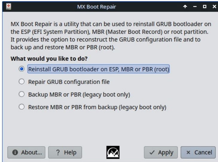
Figura 3-7: Pantalla principal de Boot Repair, con la opción más común seleccionada.
